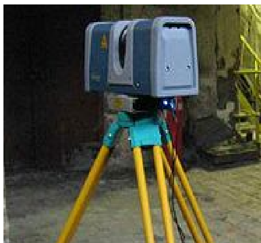
Рис. 1. Лазерный сканер - оборудование для выполнения высокоточного лазерного сканирования
